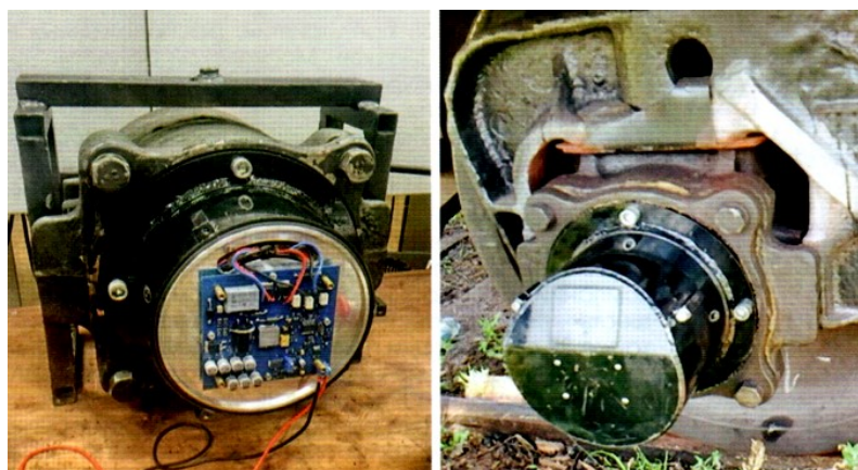
Рисунок 3 – Внешний вид буксового устройства контроля БУК-В и установка его на тележку грузового вагона
