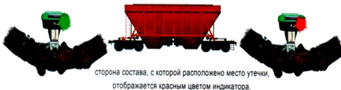
Рисунок 2 – Пример индикации стороны состава, с которой расположено место индикации
