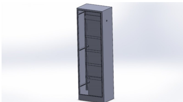
Рисунок 3 – Пустой силовой шкаф
