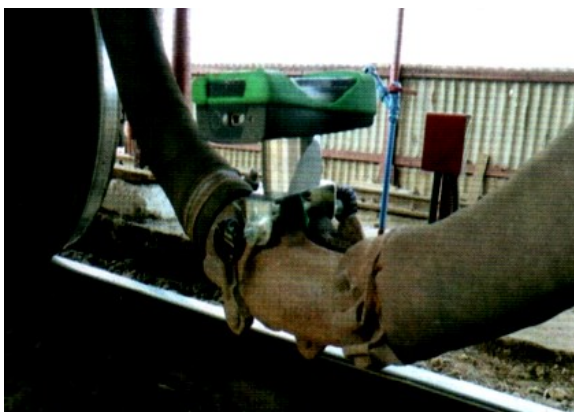
Рисунок 1 – Индикаторы приспособления «Поиск», установленные между головками соединительных рукавов
