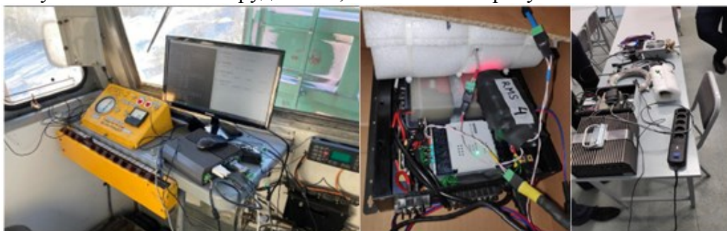
Рисунок 1 – Измерительное и коммуникационное оборудование, устанавливаемое на электровозе
