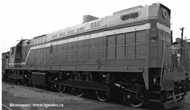
Рисунок 2 – Маневровый локомотив ТЭМ7А, работающий без машиниста
