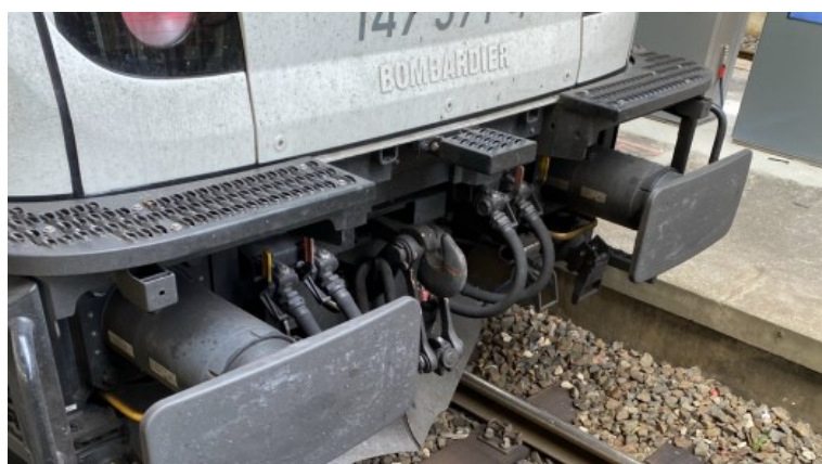
Рисунок 2 – Тип сцепки на винтовой стяжке
